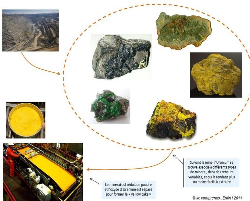
Le *yellowcake* est ensuite purifié puis oxydé en oxyde d'uranium ( $U_3O_8$ ). On le transforme ensuite en hexafluorure d'uranium ( $UF_6$ ) pour pouvoir l'enrichir en  $U^{235}$  (de 0,7% à 3-5%) par diffusion gazeuse ou centrifugation sélective.
