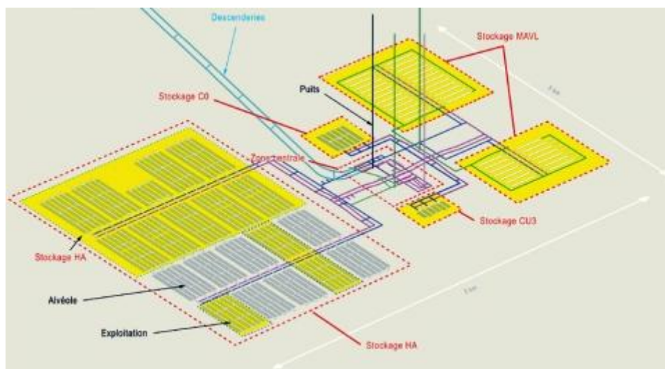
modélisation récente du stockage : la partie de droite est destinée à accueillir les MA, la partie centrale les déchets anciens et celle de gauche les HA à partir de 2075.
